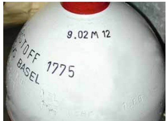
Figura 24: data di controllo sulla spalla della bombola
