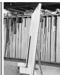
Soluzione 1.5 Carrello portapannelli conforme ai requisiti di sicurezza, provvisto di dispositivo antiribaltamento e spostamento del carrello per le operazioni di carico e scarico pannelli. Il baricentro si trova fra le ruote in mezzo al carrello.
