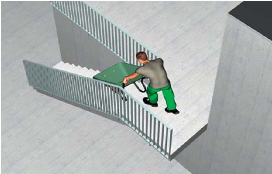
01 // Auf der Rückseite des Treppenpodests fehlte eine Absturzsicherung. Dies hatte für einen Arbeiter tödliche Folgen. // Suva
