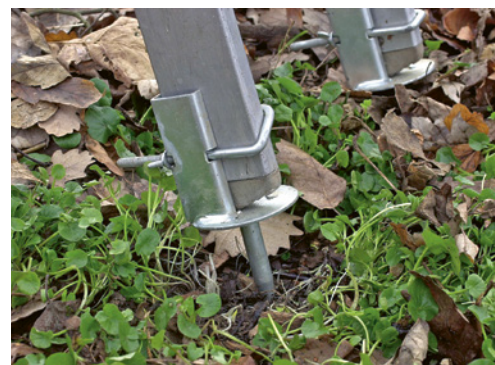
3 Auf weichem Boden dienen Metallspitzen als Rutschsicherung der Leiter.
