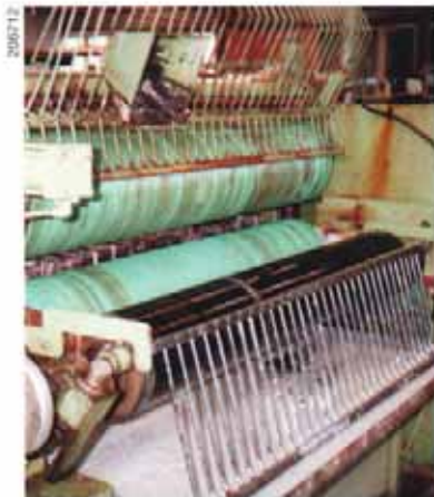
Bild 30: Vier-Walzen-Leimaufragsmaschine in einem Holzbearbeitungsbetrieb.
