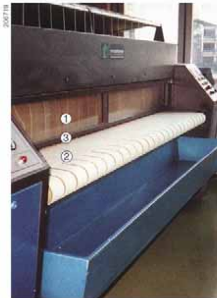
Bild 37: Mehrmulden-Glättmaschine in einer Wäscherei. Die Einlaufstelle zwischen der Walze (1) und den einlaufenden Gurten (2) ist mit einer Schaltklappe (3) gegen Zugriff gesichert. Beim Anstossen an die Schaltklappe werden die Gurten sofort stillgesetzt und die Walzen von den Heizmulden abgehoben. (Weitere Informationen über Schaltklappen siehe Abschnitt „Schutzeinrichtungen mit Annäherungsreaktion“ auf Seite 18.)
