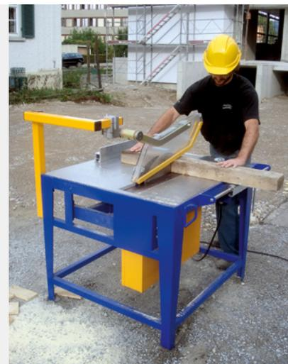
La cape de protection B 90 mise au point par des spécialistes de la prévention des accidents de la Suva et des professionnels du bâtiment a permis d'obtenir une nette réduction de la fréquence des accidents liés à l'utilisation de scies circulaires de chantier.
