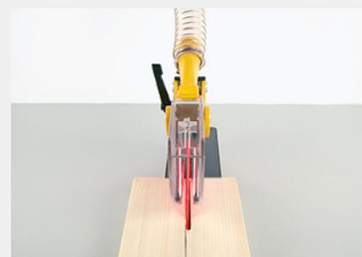
La cape de protection et d'aspiration S 250 est spécialement conçue pour les scies circulaires à table mobiles ou de petite dimension. Elle est fixée au couteau diviseur et peut être facilement raccordée, au moyen d'un tuyau de 38 mm de diamètre intérieur, au dispositif d'aspiration des copeaux.
