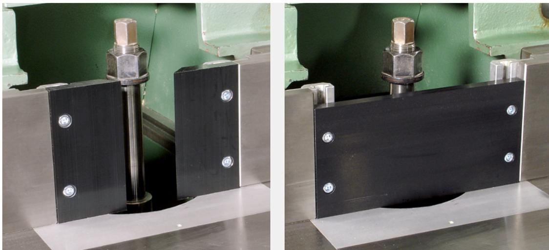
La lèvre de guide et la planchette de fraisage sont des pièces d'usure devant être remplacées de temps à temps afin de permettre un travail soigné.
