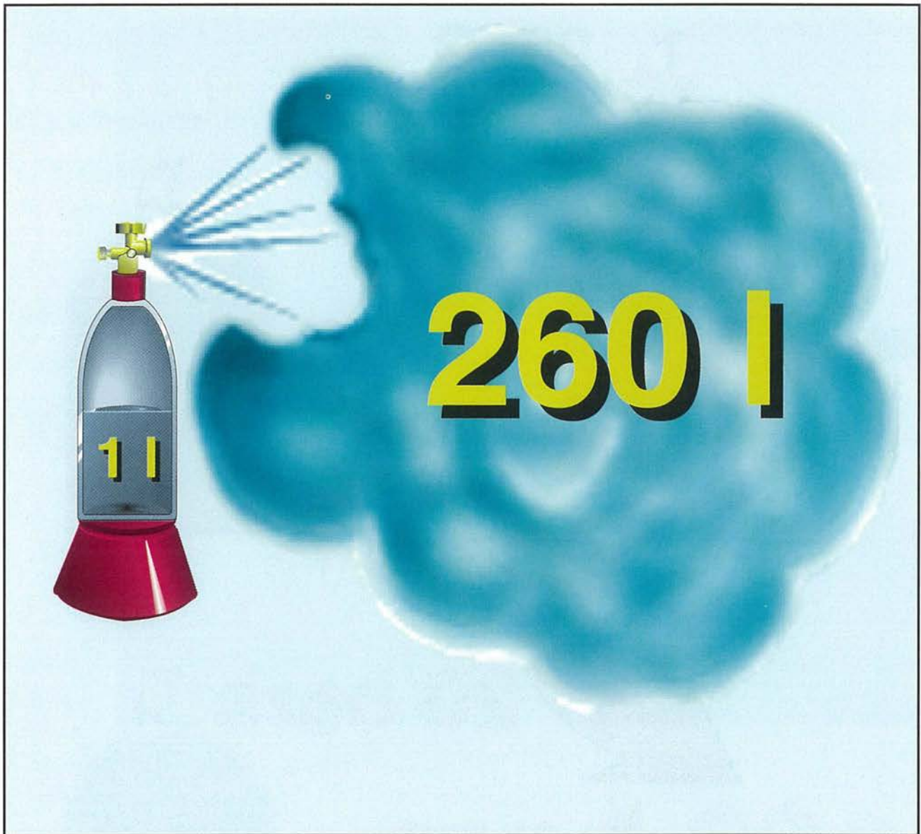
Figure 10: Expansion volumique du propane lors de la vaporisation
