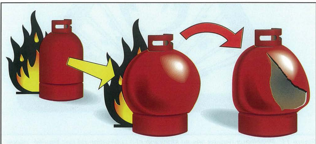
Figure 12: Effets des flammes sur une bouteille de gaz liquéfié
