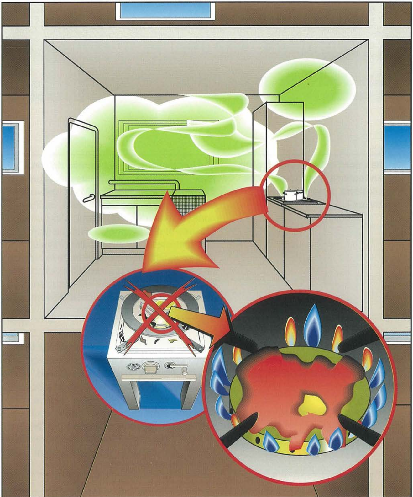
Figure 17: Formation de CO résultant de l'utilisation d'un brûleur encrassé
