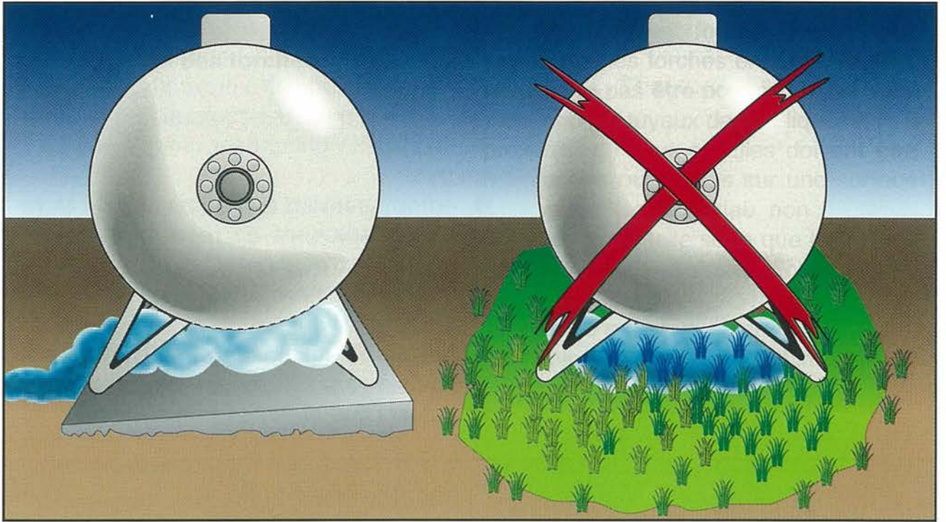
Figure 25: L'installation du réservoir sur un plan incliné dans un sens approprié permet d'exclure le risque d'inflammation sous le réservoir
