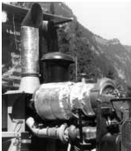
Figura 5: filtro antiparticolato isolato contro la radiazione termica. Bisogna evitare che il calore renda fragili le tubazioni e che gli aggregati (ad es. l'alternatore) possano danneggiarsi.
