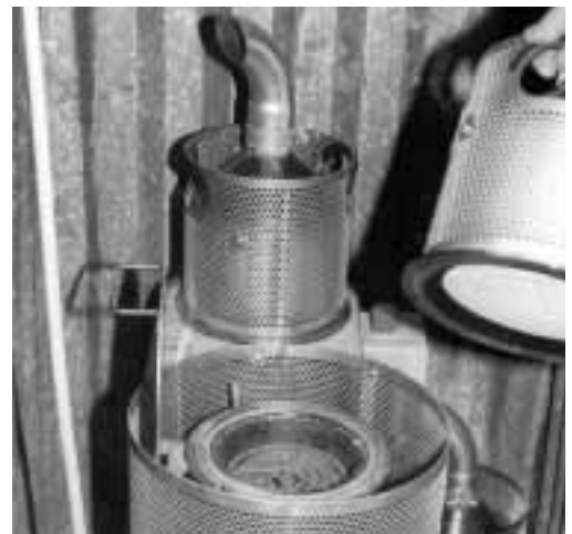
Figura 2: camera di combustione per la rigenerazione dei filtri intercambiabili.
