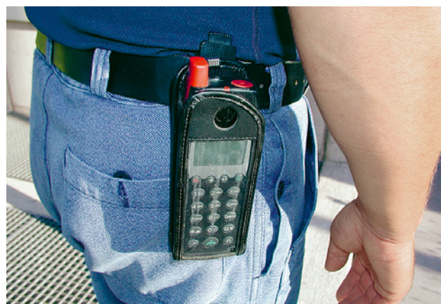
34 Auricolare con dispositivo di segnalazione di emergenza integrato. È necessario predisporre un'organizzazione di allarme adeguata.
