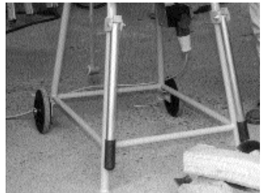
Figura 5: Organo di presa a maniglia e ruote grandi facilitano il trasporto della macchina spaccalegna.
