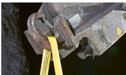
1 Point d'attache équipé d'un crochet de sécurité
