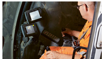
3 Engin de chantier équipé d'une caméra de recul
