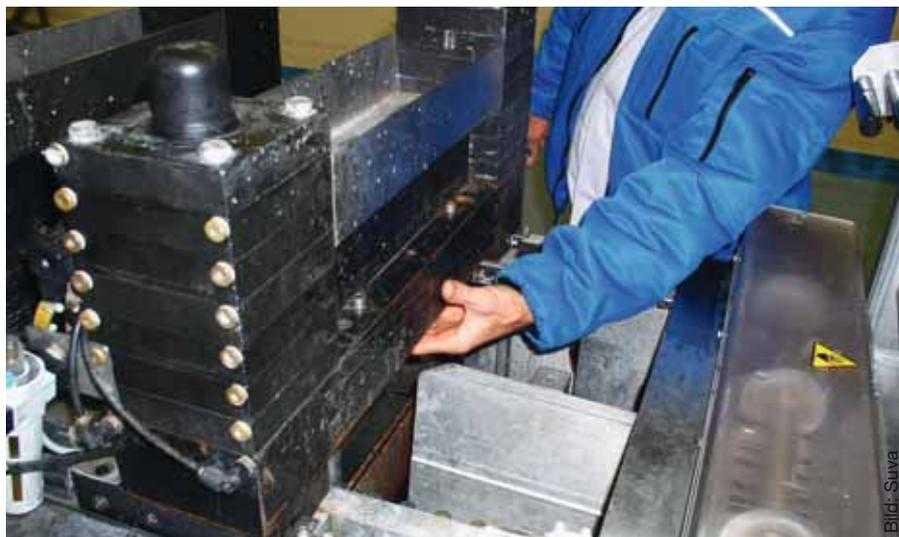
01 // Der Mitarbeiter wechselte die Messer an der Schneidestation aus. Währenddessen konnte die Maschine trotz geöffneter Schutzeinrichtung starten, weil das Sicherheits-Relais überbrückt war (gestellte Unfallsszene). // Bild: Suva
