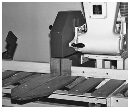
3 Guide empêchant tout contact avec la lame en position initiale. Fente pour le passage de la lame inférieure à 12 mm. Table de la machine dépassant la course maximale de la lame.
