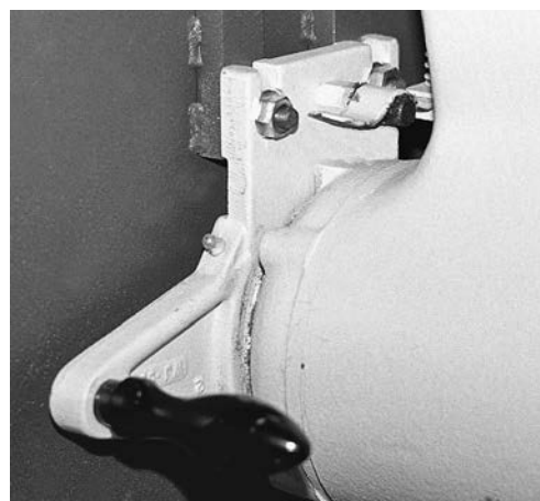
1 Poignée isolée et dispositif de maintien de la lame en position initiale (lame-ressort et tourillon).
