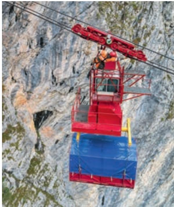
Photo prise par un drone lors du contrôle détaillé d'un câble de traction sur la nacelle du téléphérique Eggi-Äppigen.
