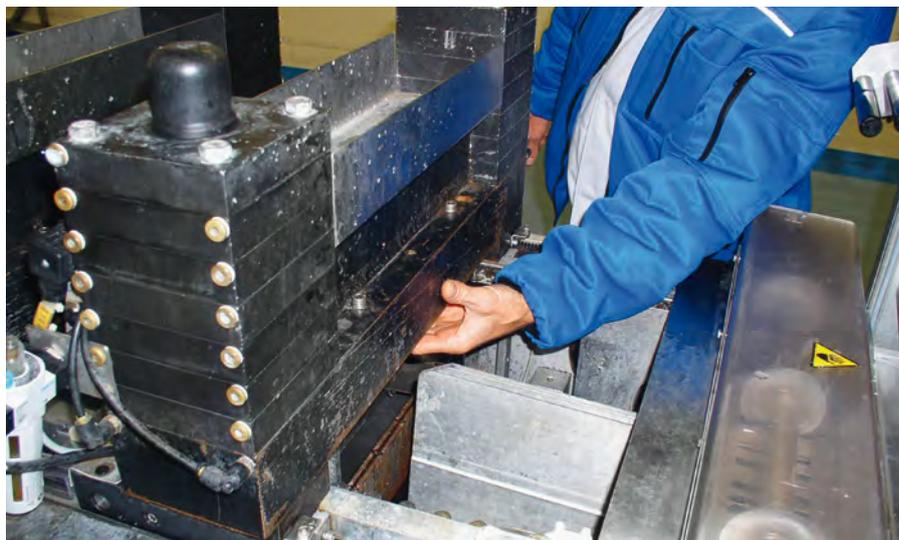
01 // Le collaborateur remplace les couteaux. Pendant ce temps, la machine se met en marche malgré le dispositif de protection, du fait que celui-ci a été manipulé (reconstitution). // Photo: Suva
