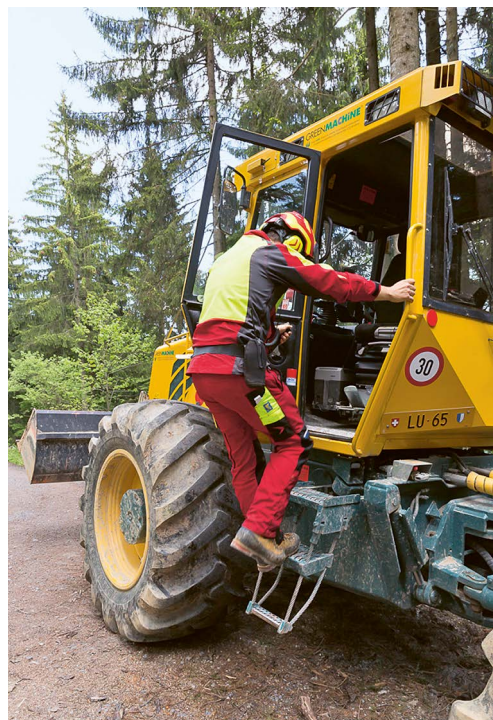
1 Montée et descente correctes de l'engin
