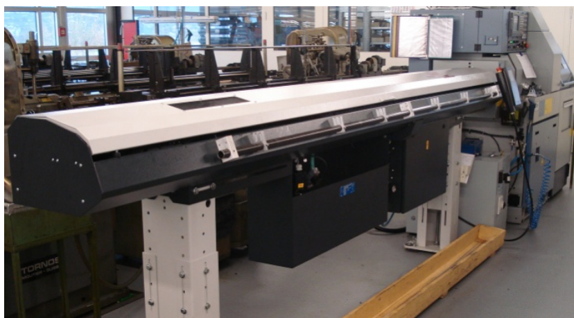
1 Embarreur à rampe de chargement latérale
