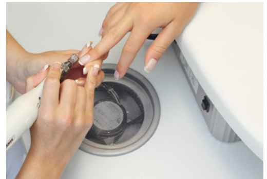
Bild 9: Nagelbearbeitungstisch mit Absaugeinrichtung
