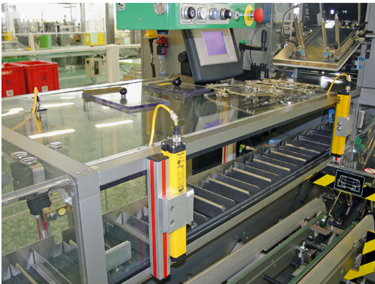
Wenn ein Mitarbeitender in den Bereich hinter den Lichtschranken greift, steht die Maschine sofort still.
