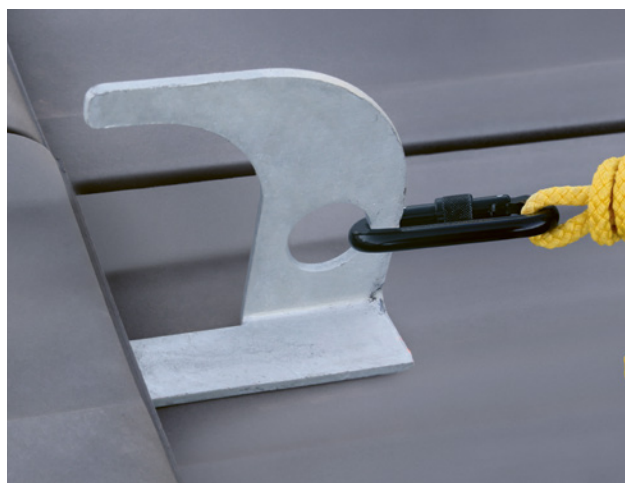
Fig.4 Protection contre les chutes: le crochet de sécurité pour toit utilisé pour fixer l'échelle est conforme à la norme EN 795 ou EN 517; il sert également de point d'ancrage pour la corde de sécurité.
