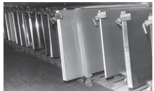
Fig. 4: paquets de tôles entreposés sur des chariots spéciaux.
