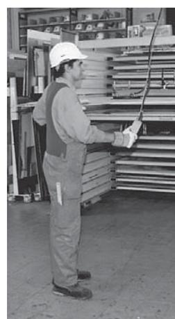
Fig. 8: les équipements de protection individuelle (gants, chaussures, casque de protection) ainsi que l'utilisation d'accessoires adaptés réduisent les risques d'accident.
