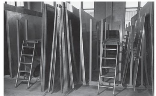
Fig. 2: entreposage vertical de tôles dans des râteliers avec passerelle de service.
