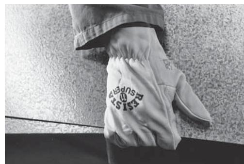
Fig. 9: les gants de protection contre les coupures protègent les mains contre les arêtes vives.
