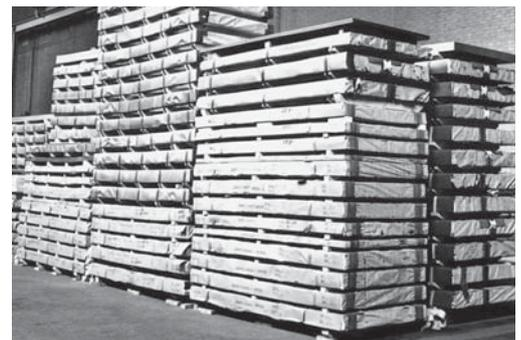
Fig. 5: des carrelats de bois entre les paquets de tôles facilitent le désempilage avec un chariot élévateur.
