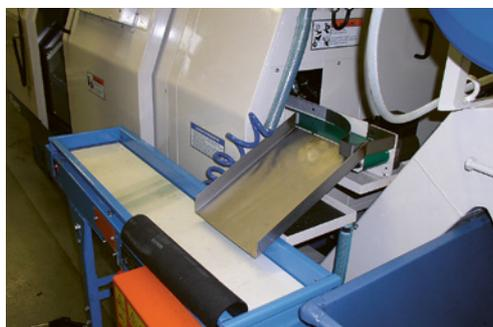
3 Espulsore pezzi su nastro trasportatore
