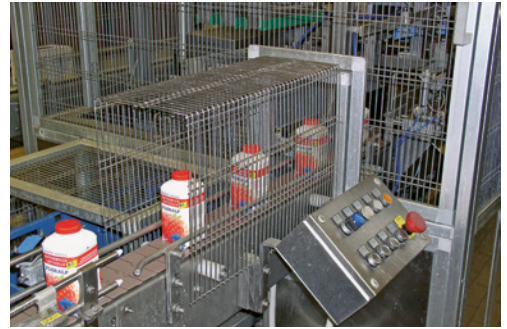
1 Il tunnel impedisce l'accesso (distanza dalla zona pericolosa \geq 850 mm).
