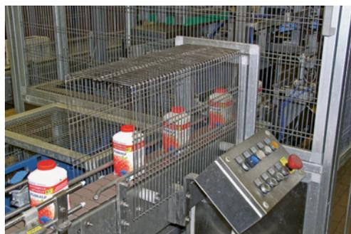
1 Il tunnel impedisce l'accesso (distanza dalla zona pericolosa  $\geq 850$  mm).
