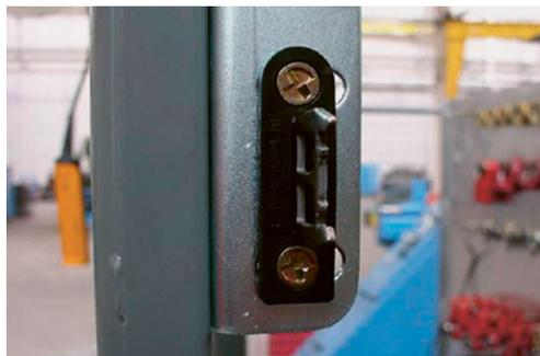
4 Evitare le manipolazioni, per es. fissando l'attuatore dell'interruttore di controllo con viti non removibili (fig.), saldandolo, rivettandolo o perforando la testa delle viti, tappandolo od otturandolo con sfere di acciaio.
