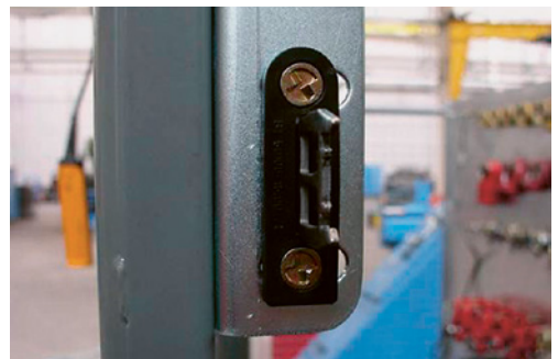
4 Evitare le manipolazioni, per es. fissando l'attuatore dell'interruttore di controllo con viti non removibili (fig.), saldandolo, rivettandolo o perforando la testa delle viti, tappandolo od otturandolo con sfere di acciaio.
