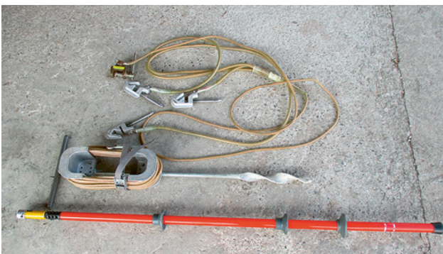
1 Erdungsgarnitur Hochspannung (Erdungsgarnituren müssen dynamischen und thermischen Beanspruchungen standhalten.)
