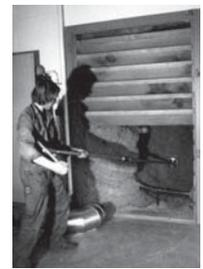
Bilder 5 und 6: Geeignete Werkzeuge für den Abbau des Spänestockes:
