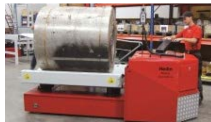
Bild 7 und 8 Mit Dornwagen, Dornstapler oder speziellen Coil-Transportwagen können Bandstahlröhrchen und Coils mit horizontaler Achse sicher transportiert werden.
