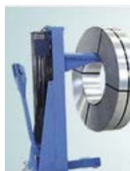
Bild 7 und 8 Mit Dornwagen, Dornstapler oder speziellen Coil-Transportwagen können Bandstahlröhrchen und Coils mit horizontaler Achse sicher transportiert werden.
