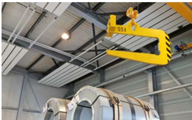
Bild 5 Für den Krantransport grosser Coils mit horizontaler Achse eignen sich z.B. C-Haken mit Gegengewichtsausgleich.
