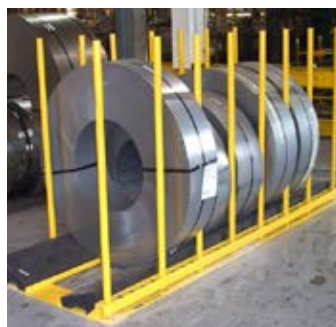
Bild 3 Das Lagergestell verhindert, dass die Bandstahlringe kippen.
