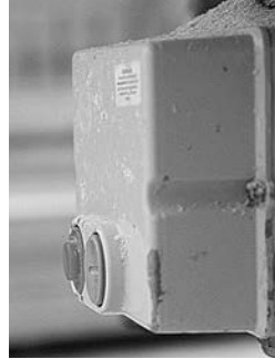
1 Une collerette ou un interrupteur positionné en contrebas permettent de prévenir une mise en service involontaire de la scie circulaire.
