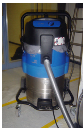
2 Aspirateur industriel de classe H (amiante)
