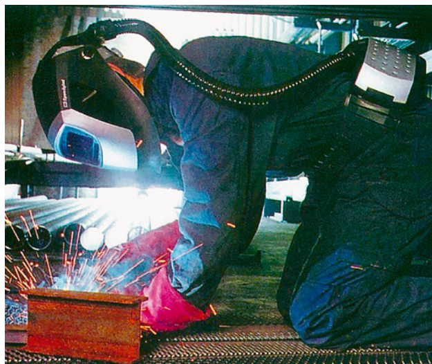
Figura 41 Elettrorespiratori con casco o cappuccio a filtro antigas e a particelle combinato conformi alla norma SN EN 12941 (livello di protezione TH2 A1 E1 B1 P)
