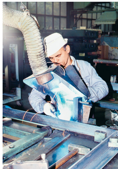
Figura 35 Aspirazione a mezzo tubo regolabile
