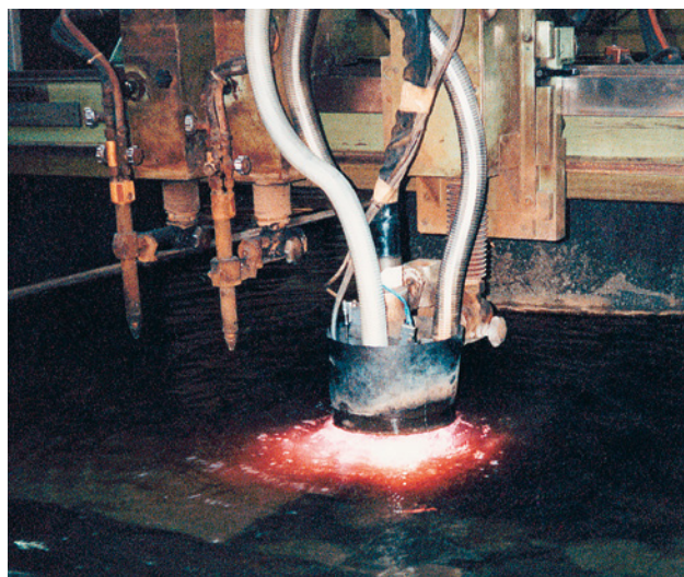
Figura 31 Taglio subacqueo al plasma di acciai al cromo-nichel
