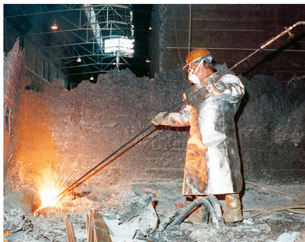
Figura 25 Taglio autogeno con lancia d'ossigeno
