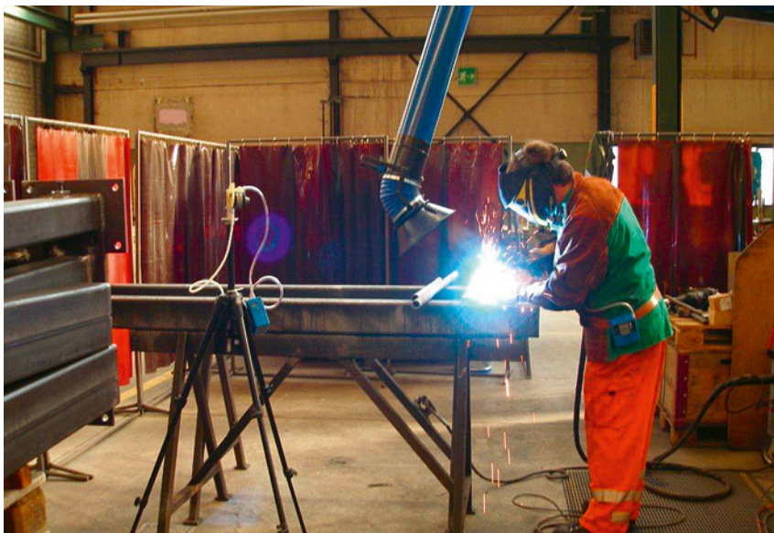
Figura 34 Aspirazione incorporata nello schermo da saldatore
