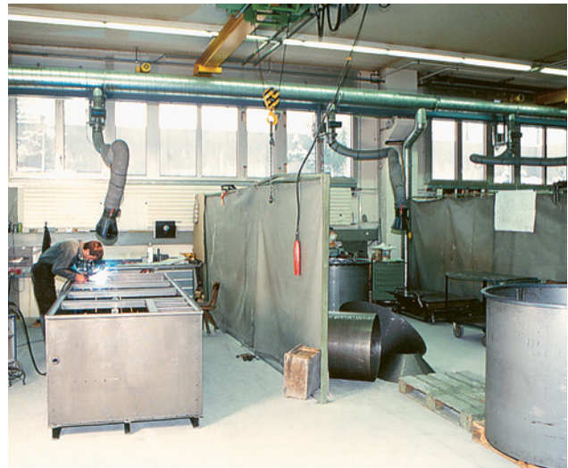
Figura 36 Ampio raggio d'azione del braccio flessibile dell'impianto d'aspirazione
