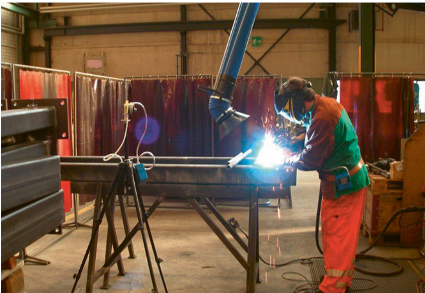
Figura 34 Aspirazione incorporata nello schermo da saldatore
