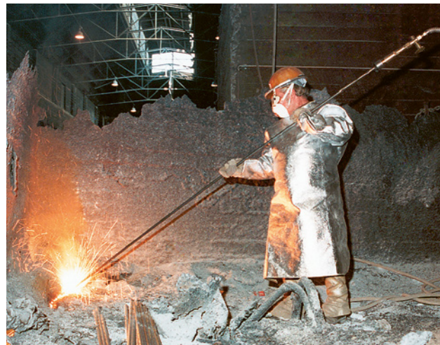
Figura 25 Taglio autogeno con lancia d'ossigeno
