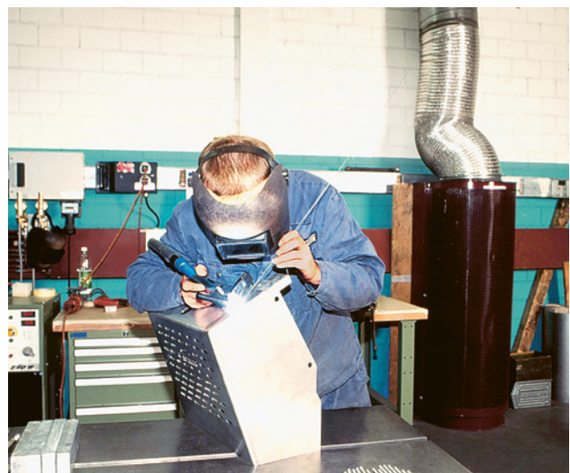
Figura 37 Ventilazione ad aria fredda
