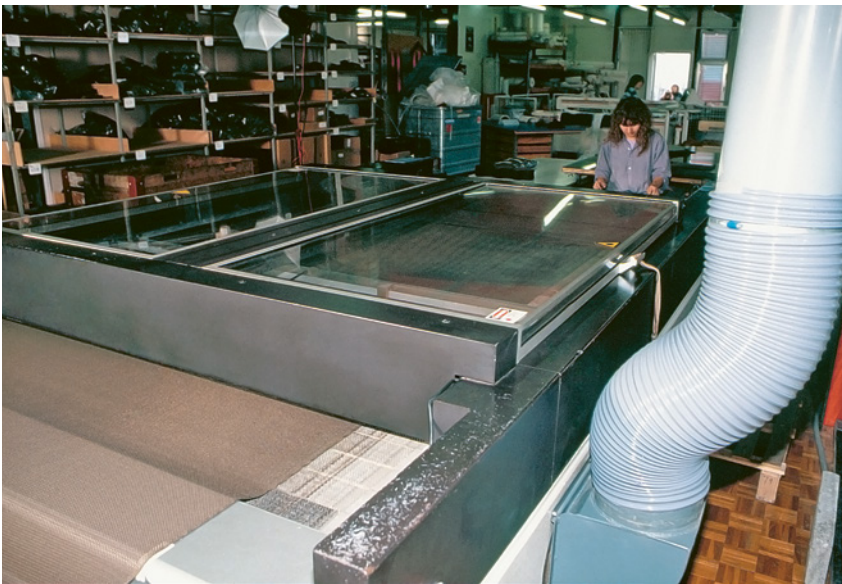
Figura 32 Incapsulamento e aspirazione in un impianto di taglio laser
