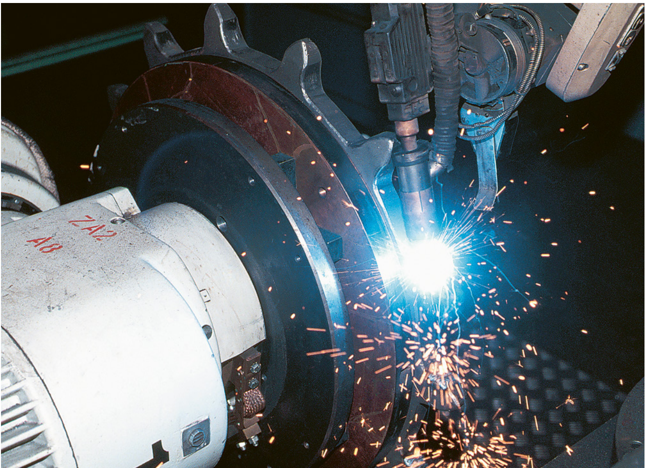
Figura 5 Saldatura automatica di riporto
