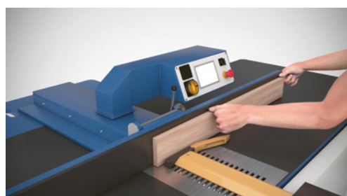
6 Posizione delle mani durante la piallatura sul filo
