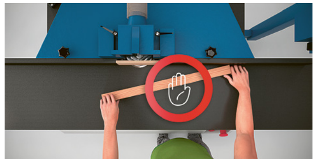
Falsches – sehr gefährliches Einfahren
