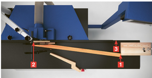
Richtiges – sicheres Einfahren
