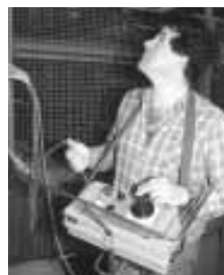
Figure 6: manœuvres de révision sûres: - zone de travail sûre pour l'opérateur, - vue directe sur le transtockeur, - contrôle des mouvements grâce à la commande à action maintenue, - mouvements en vitesse réduite.
