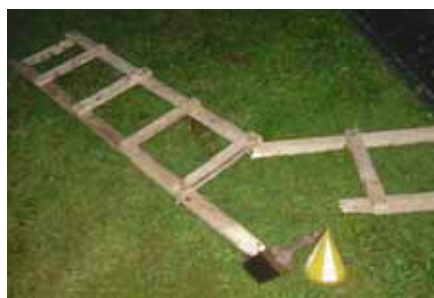
02 // Echelle de couvreur bricolée par le peintre ayant subi l'accident.
