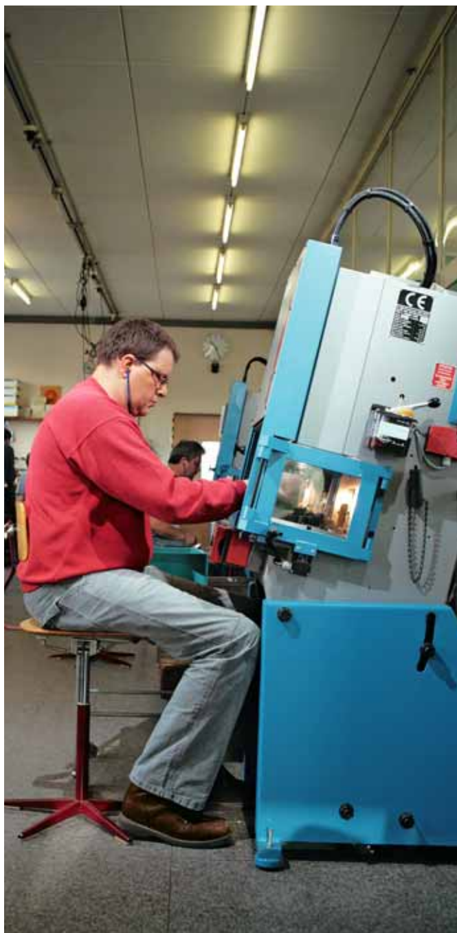
01 // Le dispositif de protection sur les nouvelles presses – écran amovible et mécanisme activé par pédale – assure une sécurité absolue.
