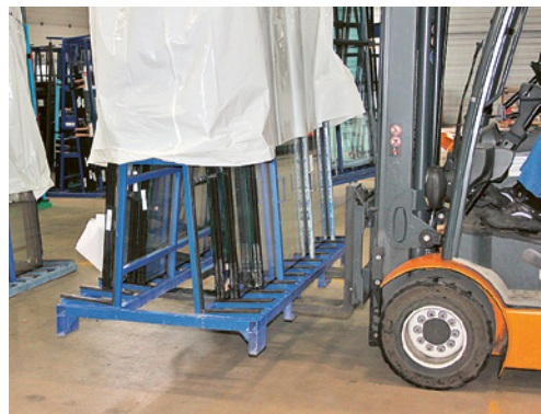
8 Rastrelliera provvista di barre guida per i carrelli elevatori a forche
