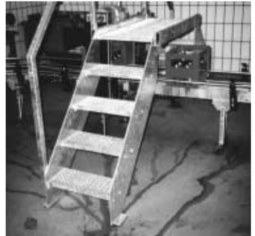
Bild 7: Laufsteg über eine Rollenbahn.
