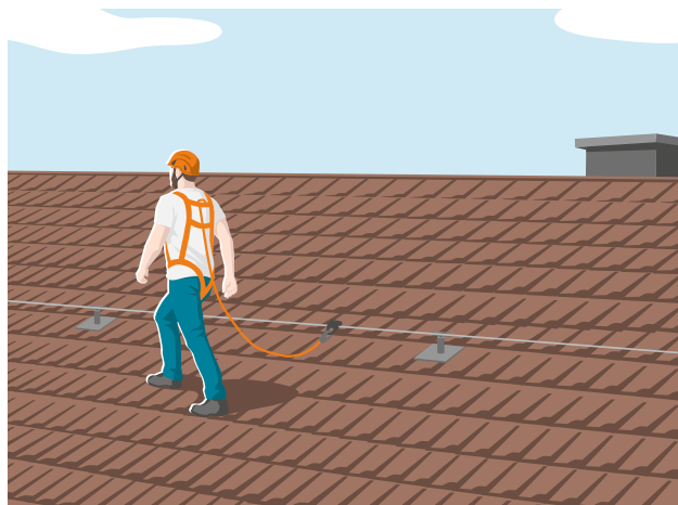
15 Fest installierte Absturzsicherung (Drahtseil)
