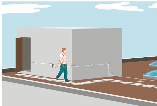
25 Sicherer Zugang auf ein Flachdach für Arbeiten von kurzer Dauer
