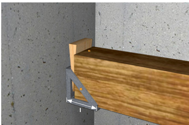
10 Le carret a une longueur d'appui suffisante. Le carret et le coin sont assemblés par un clou. Le carret est également cloué ou boulonné au sabot de support: il ne peut pas se soulever.
