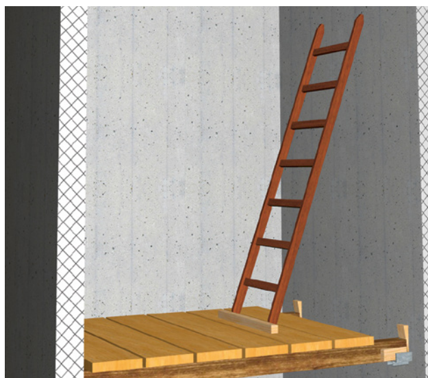
13 Règles de sécurité à observer pour travailler sur une échelle: angle d'inclinaison de 70°, accessoire antiglis, équipement en parfait état.
