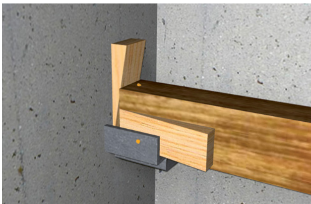
11 Les poutrelles sont sécurisées contre le risque de basculement à l'aide de coins.
