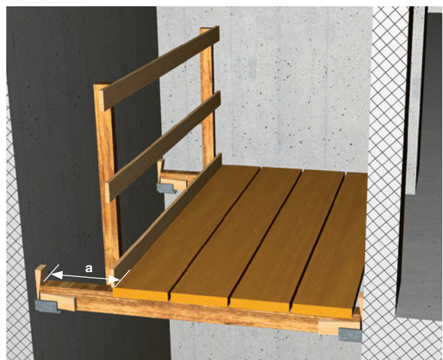
6 Lorsque la distance [a] dépasse 30 cm, un garde-corps permet de prévenir les chutes.
