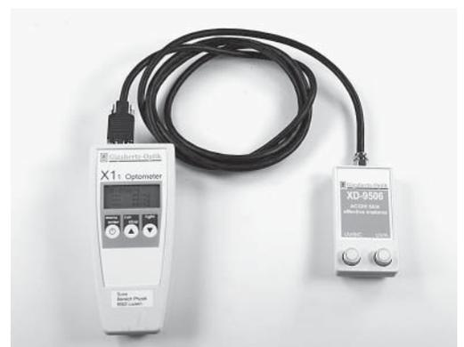
Fig. 3: Un optomètre calibré est utilisé pour mesurer l'intensité de rayonnement.
