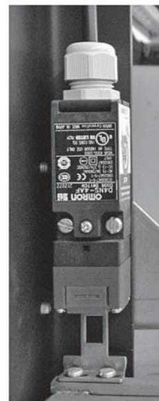
Fig. 2: Un commutateur à ouverture forcée désactive la lampe UV ou referme l'écran en cas d'ouverture de l'installation.
