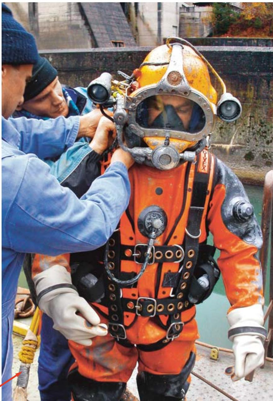
**Figure 6a** Plongeur professionnel équipé pour les travaux de construction et de montage sous l'eau, avec une solide tenue de plongée étanche et un casque en composite de fibres de verre ou de carbone avec masque respiratoire intégré, téléphone et lampe. Alimentation depuis la surface par un tuyau (flèche). Nécessité du personnel auxiliaire.
