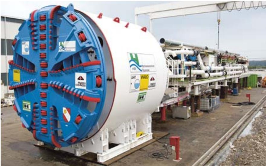
**Figure 9b** Vue de l'avant en direction de la roue d'abattage, avec le bouclier (peint en blanc) et derrière celui-ci le train suiveur (sous le derrière celui-ci) contenant les installations de la machine et le matériel de tubage du tunnel.
