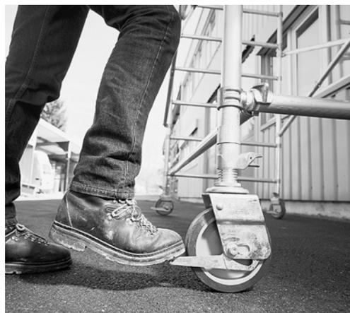
4 Per evitare lo scivolamento del ponteggio bisogna bloccare le ruote.
