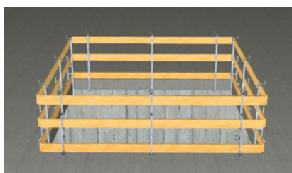
1 Grande apertura con protezione laterale a tre elementi
