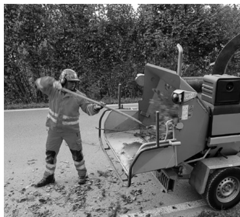
5 Gli scarti vegetali vengono appoggiati sui rami più grandi e poi spinti tra i rulli con un bastone lungo.
