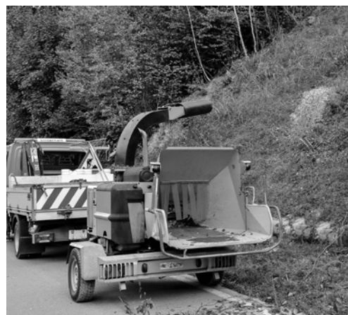
4 Le persone non devono sostare nei pressi della bocca di espulsione. Bisogna anche prestare attenzione al transito dei veicoli.
