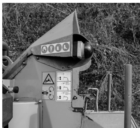
2 Le funzioni della staffa di comando devono essere segnalate in modo chiaro e ben visibile sulla tramoggia di alimentazione.
