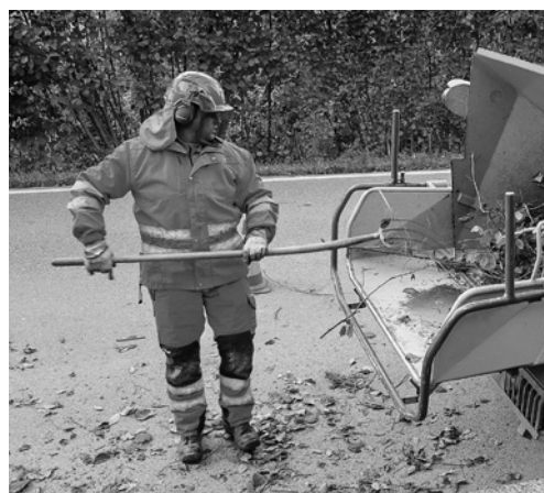
6 Tra i dispositivi di protezione individuale non devono mancare il casco di protezione, i protettori per occhi e udito, calzature solide, indumenti ad alta visibilità aderenti e guanti con polsini stretti.
