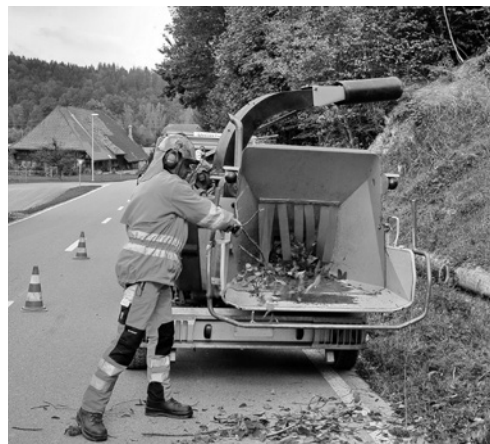
1 La staffa di comando posizionata a lato e al di sotto della macchina riveste anche il ruolo di dispositivo di arresto. Ci sono inoltre due dispositivi di arresto di emergenza.
