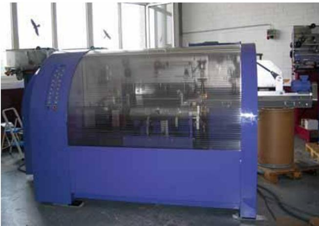
21 Encoffrage d'une machine fabriquant des boîtes de conserve.
