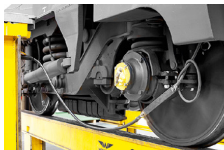
14 Veicolo sollevato ed equipaggiato con una messa a terra.
