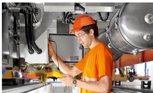
4 Se si lavora sotto ai veicoli è obbligatorio indossare una protezione della testa (copricapo antiurto o casco di protezione).
