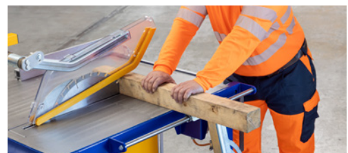
3 Die Suva-Schutzhaube B90 senkt sich automatisch in die Schutzstellung ab und bietet dadurch eine besonders hohe Schutzwirkung. Die Verwendung einer Schutzhaube mit Selbstabsenkung wird deshalb dringend empfohlen.
