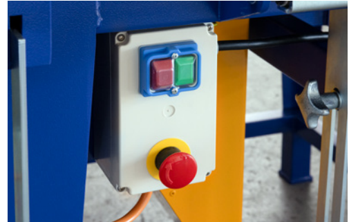
1 Steuereinheit mit Nothalteinrichtung und versenkt angeordneten Einschalttasten gegen unbeabsichtigtes Einschalten
