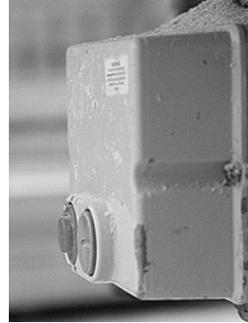
1 Als Sicherungen gegen unbeabsichtigtes Einschalten kommen zum Beispiel in Frage: Schutzkragen, versenkte Anordnung der Einschalttaste.
