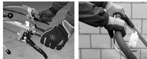
5 e 6 Dispositivo uomo morto con manopola e staffa
