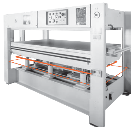
Fig. 3: il bordo sensibile alla pressione o la fune a strappo impedisce che l'operatore rimanga schiacciato sotto il banco.
