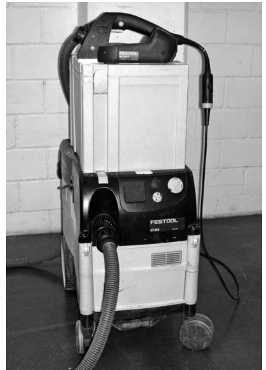
Bild 4: Handhobelmaschine mit Absaugvorrichtung
