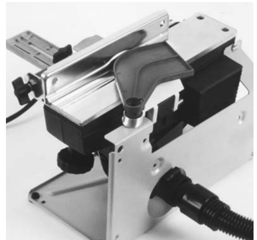
Bild 2: Handhobel im Stationärbetrieb mit Wellenverdeckung und Halterung.
