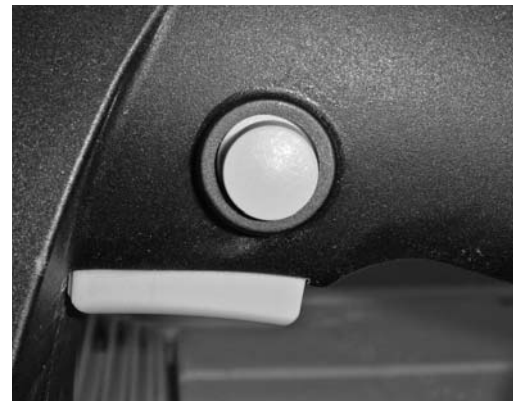
Bild 3: Die Sperrsicung verhindert, dass der Dauerbetrieb unbeabsichtigt eingeschaltet ist.
