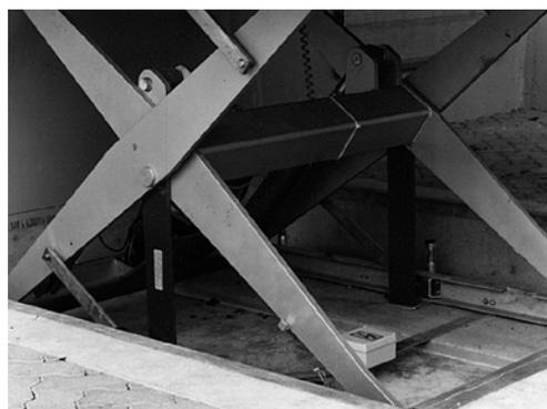
9 I dispositivi di blocco (puntelli), quando si trovano in posizione di sicurezza, proteggono gli operatori dall'abbassamento accidentale della piattaforma.
